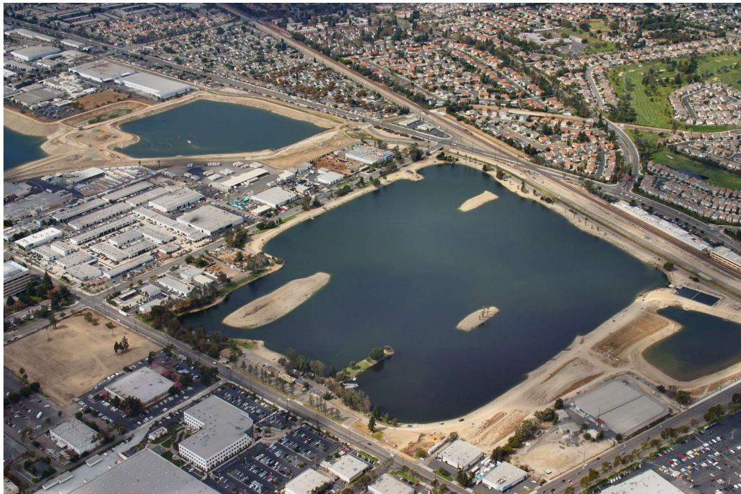
L'eau produite est à 50% injectée dans des aquifères côtiers pour lutter contre les intrusions salines, et à 50% acheminée vers un lac, d'où elle s'infiltra lentement dans le sol et rejoint les aquifères.
